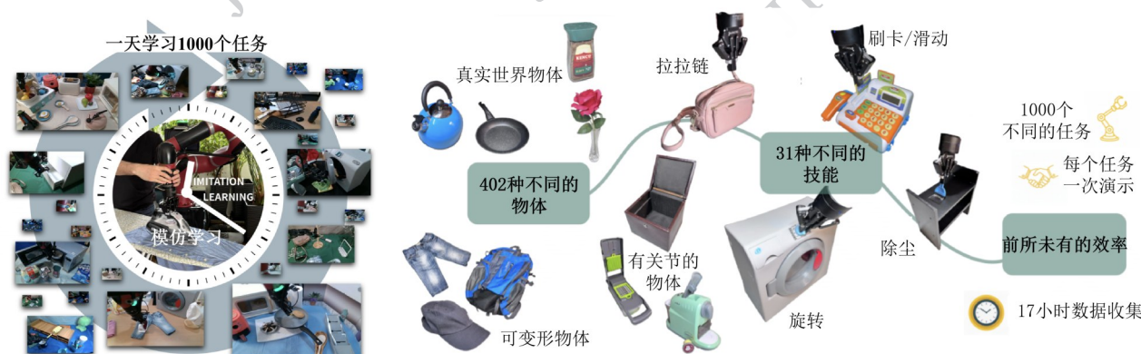
图6 机器人通过单次示范快速学习1000个日常任务(覆盖402种真实世界物体、31类核心技能)(Dreczkowski等,2025)
